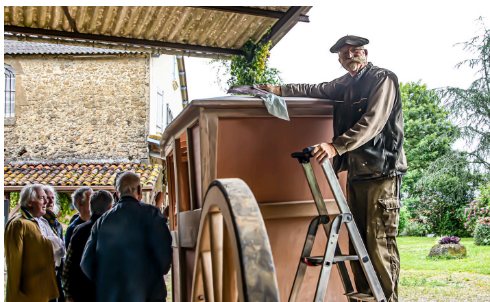
Le toit est poli avant la pose de la couverture en cuir ouvragé
