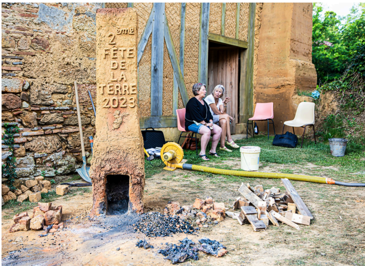
Le fourneau est ouvert, le fer refroidit à son pied
