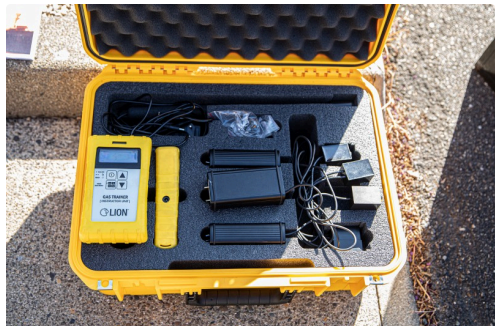
Mallette d'entraînement à la recherche de fuites de gaz
