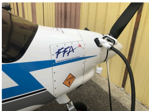
L'aérodrome possède une prise pour les avions électriques.
