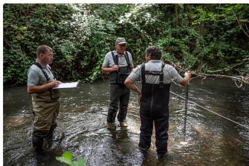
30 mesures du courant sont effectuées avec un courantomètre
