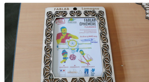
Encadrement de l'affiche réalisé par le laser en découpe 3D et dédié par la ministre.
