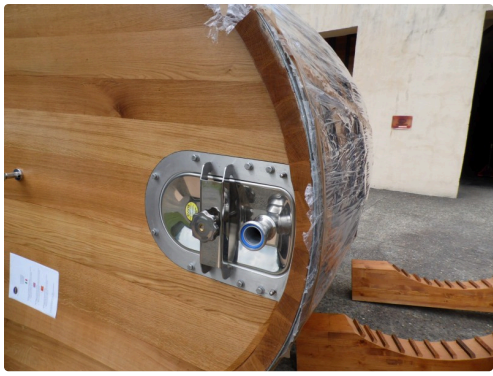
A l'avant l'ouverture d'accès du foudre, les prochaines seront "à l'ancienne" en bois
