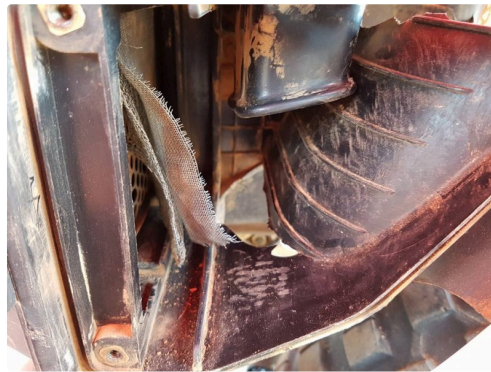
la boîte à air endommagée
