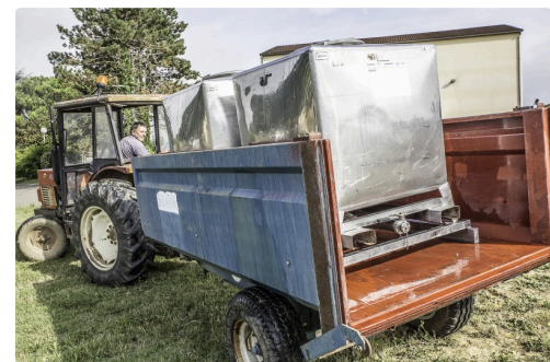
Apport d'eau pour la cuve de la machine à planter qui arrose aussi les plants
