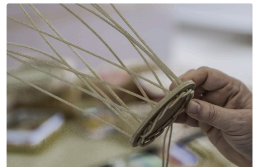
Avant cela les brins verticaux sont tressés sous le support
