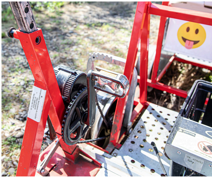
Assistance électrique sur le pédalier de gauche
