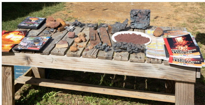
Minerai (dans l'assiette), à gauche, des lingots et, au fond, du fer brut
