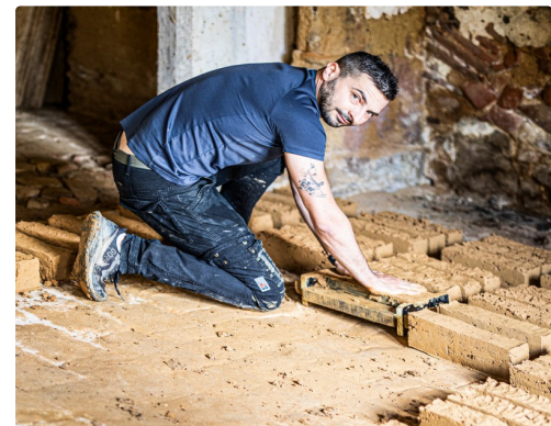
Puis il tasse la terre dans le moule
