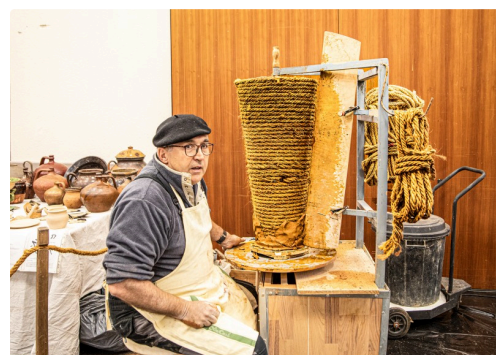
Tournage d'une jarre à la corde
