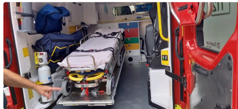
Le VSAV équipé d'un brancard hydraulique
