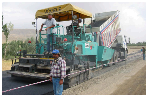
Un finisseur avec un camion-benne (photo Wikipedia)
