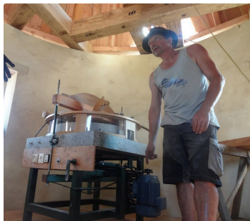
La meule pourra être actionnée aussi par un moteur électrique
