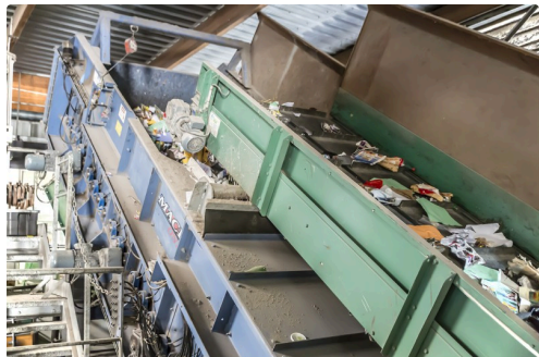
Benne de séparation par secouage au centre de tri d'Auch - Archives Roland Houdaille
